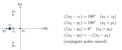
$$\angle(s_2 - z_1) - [\angle(s_2 - p_1) + \angle(s_2 - p_2) + \angle(s_2 - p_3) + \angle(s_2 - p_4)]$$
