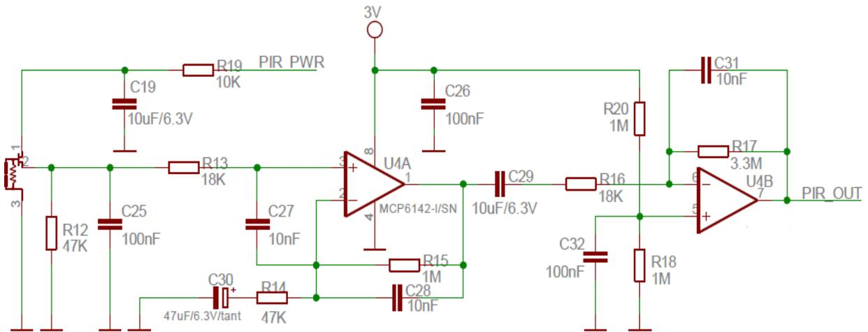
Figure 17 : PIR motion sensor circuit diagram<sup>3</sup>
