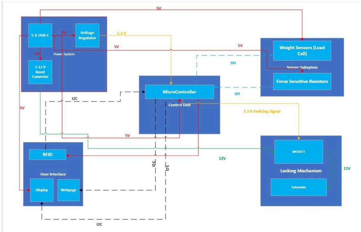
Fig. 3: Subsystem Block Diagram
