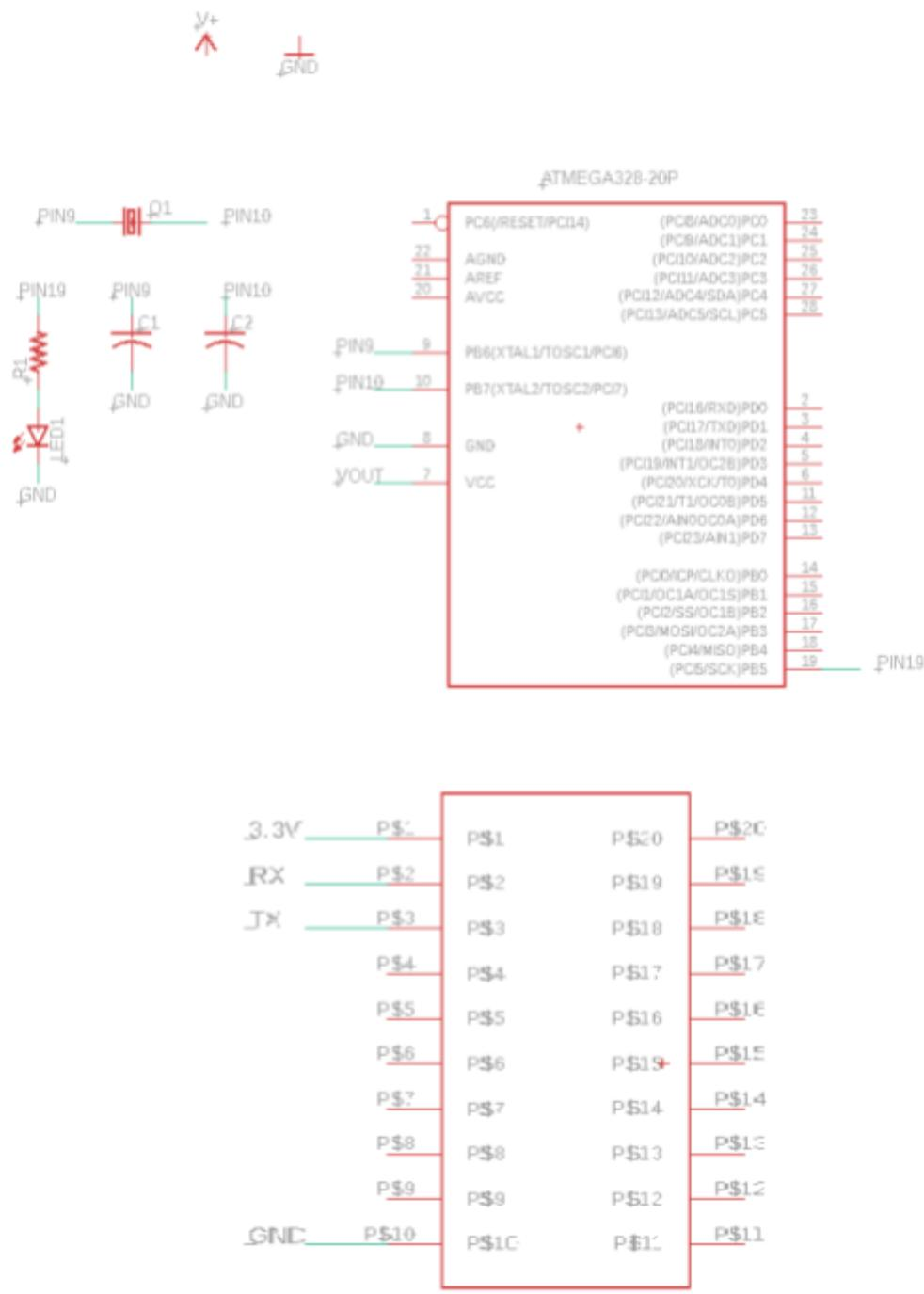
Fig.7 Atmega328P & XBEE
