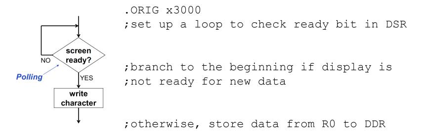
HALT DSR\_ADDR .FILL xFE04 DDR\_ADDR .FILL xFE06 .EN
